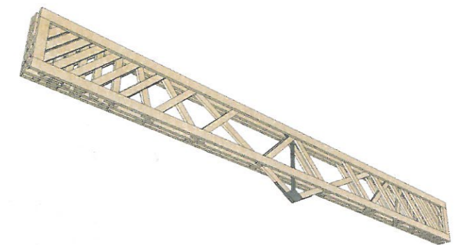
Les poutres treillis sont générées par un système constructif de plans assemblés par clouage, convenant particulièrement au peuplier Robusta non fissile.
